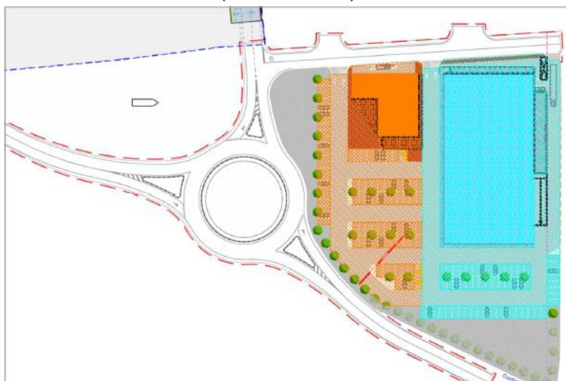
Figura 5-4 – Planimetria di progetto, superfici impermeabili con due reti di smaltimento indipendenti (arancione e blu)
