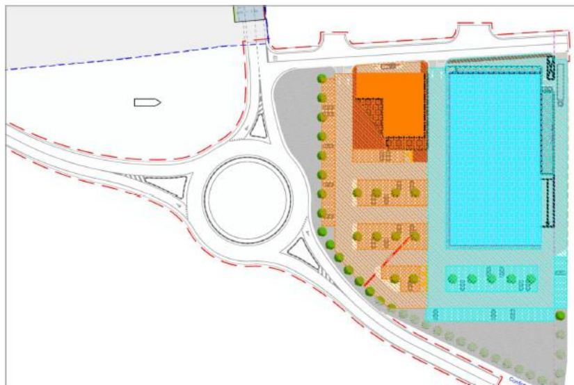
Figura 2-7 – Planimetria di progetto, superfici impermeabili con due reti di smaltimento indipendenti (arancione e blu)
